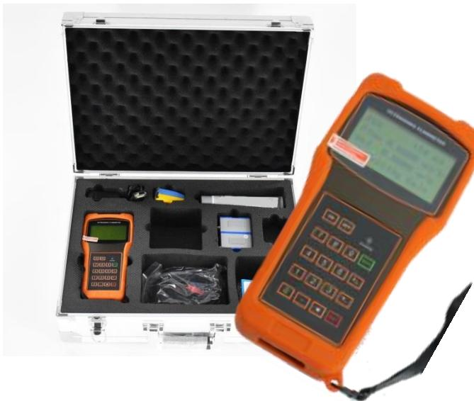
Idéal pour faire des mesures de balancement, ce débitmètre portable à ultrasons polyvalent est très simple d'utilisation. Il est compatible avec la tuyauterie PVC, CPVC, acier, inox, cuivre avec ou sans revêtement. Il est alimenté par des batteries rechargeables. Il est équipé de deux sondes à ultrasons pouvant être installées sur de la plomberie de 2" à 24". Aucun perçage n'est nécessaire, les sondes s'installent sur la tuyauterie à l'aide de colliers fournis.
